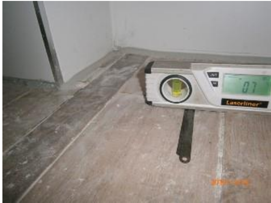
זאת בניגוד לת"י 789 (סטיות בבניינים – סטיות מותרות בעבודות בנייה יולי 2003), טבלה 3, לריצוף קרמיקה:
